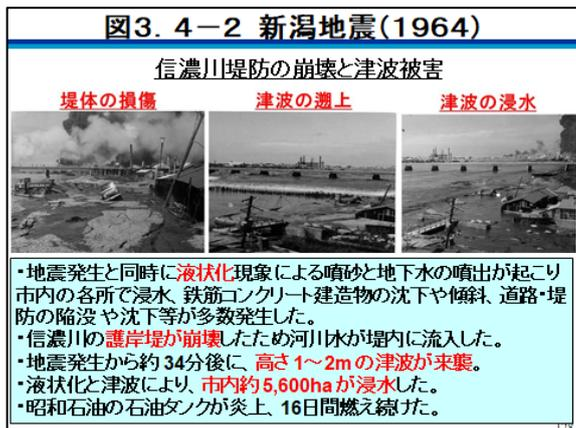
液状化で信濃川の堤防が完全に崩壊し、1～2mの津波で新潟市内5,600haが浸水したとのことです。なお、右側の写真の黒煙は長周期地震動による石油タンクの火災です。
