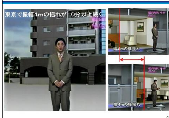
図2-31 南海トラフ地震レベル1による高層ビル
